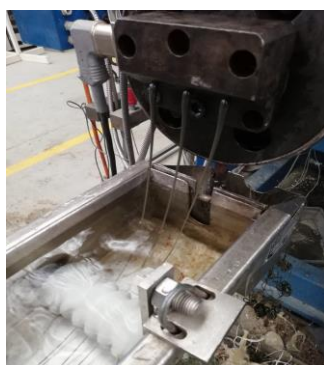
Imagen N°3: Peletizado de bolsas reutilizables de PLA y producto obtenido
