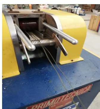
Imagen N°3: Peletizado de bolsas reutilizables de PLA y producto obtenido
